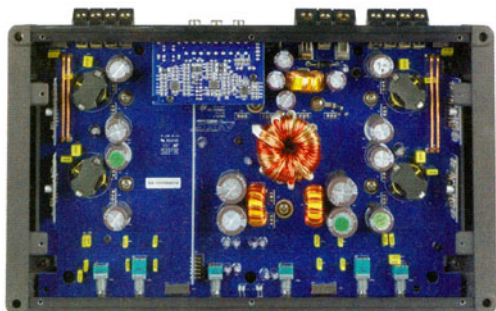
Ein Class-D-Verstärker in Reinstkultur. Lobenswert ist die gewissenhafte Ent-störung aller Spannungen.
