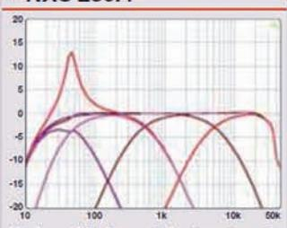
Hoch- und Tiefpass sind getrennt voneinander bis 5 kHz regelbar, per Tiefpass wird das Signal oberhalb von 30 kHz prinzipiell abgeschnitten
