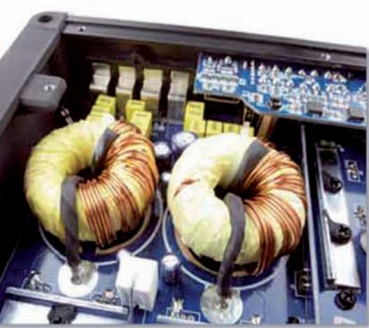
Der Monoverstärker ist eine sogenannte „Vollbrücke“. Je eine Halbwelle des Signals kann also auf einen eigenen Verstärkerzug bauen
