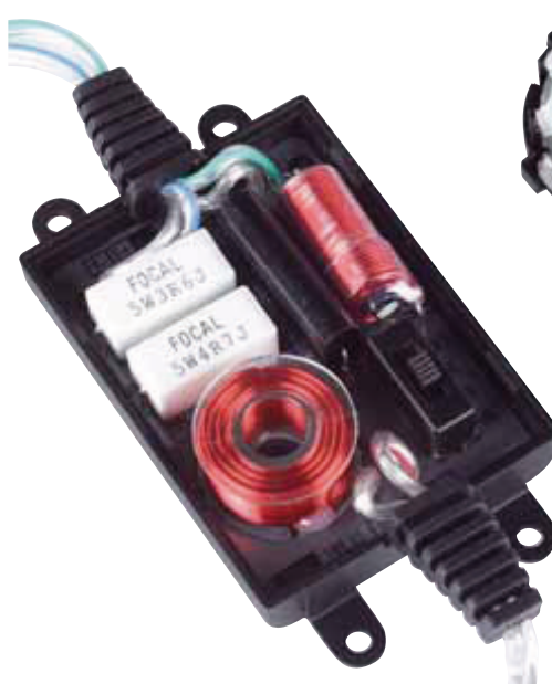
Der VW-Tweeter besitzt einen kleinen Kondensator als Kabelweiche, das Focal eine vollwertige Frequenzweiche
