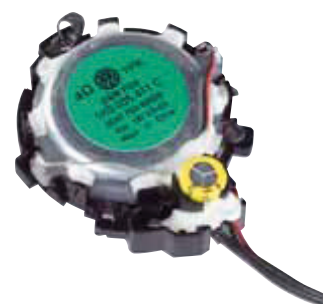
Der VW-Tweeter besitzt einen kleinen Kondensator als Kabelweiche, das Focal eine vollwertige Frequenzweiche
