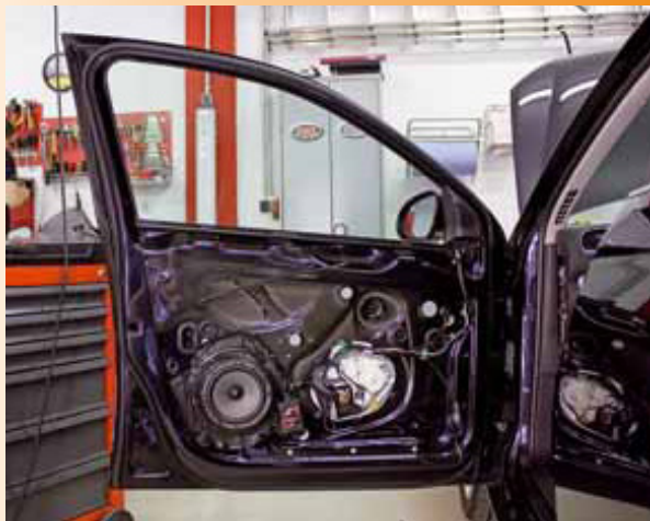
Der Focal-Tieftöner wandert mit Adapter an den Originalplatz
